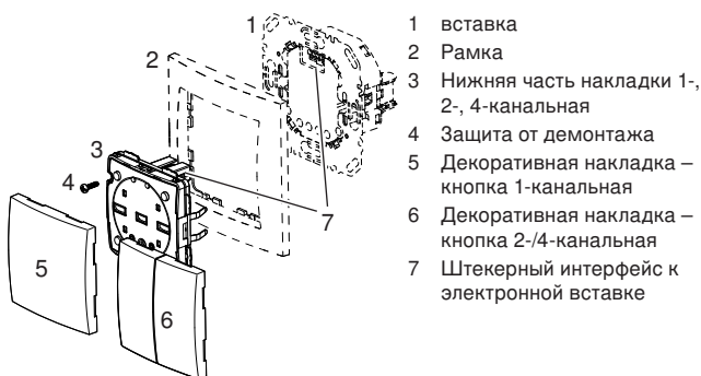
Рис. 4: Монтаж на примере KNX-Радио
